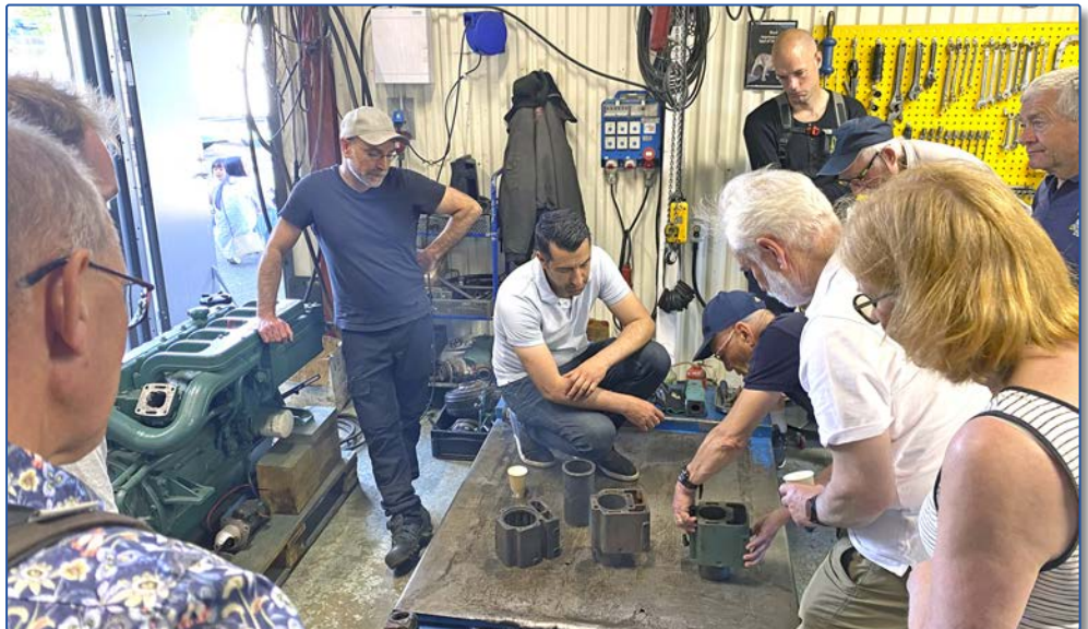
Majid och Omid visar cylindrar från MD1A, MD1B samt MD11. Den sistnämnda har lösa, utbytbara våta cylinderfoder.
