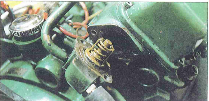
Termostathuset måste tas bort helt för rengöring. Byt samtidigt termostaten om den gamla ser ankommen ut.
