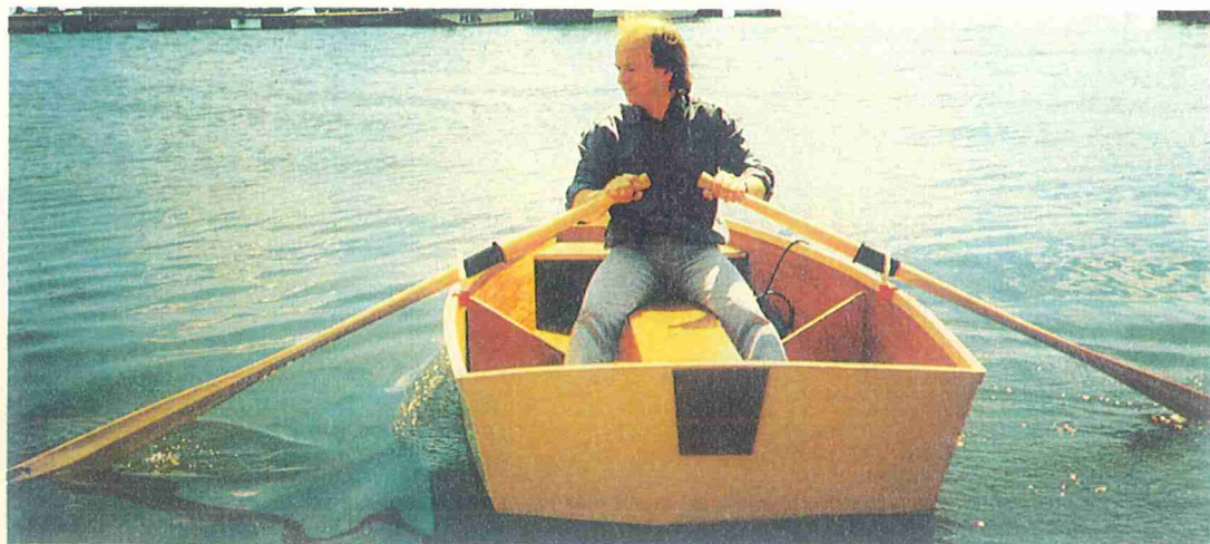
Vill man öka säkerheten på jolle kan man fylla sittlådans utrymme med flytmateriel.
