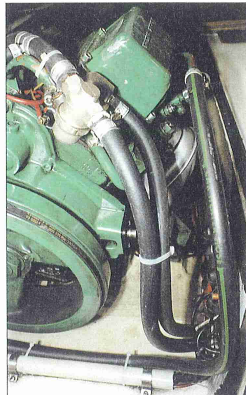
Från termostathuset, där vattnet är som hetast, kopplas slangen till värmeaggregatet. OBS det lättåtkomliga filtret!
