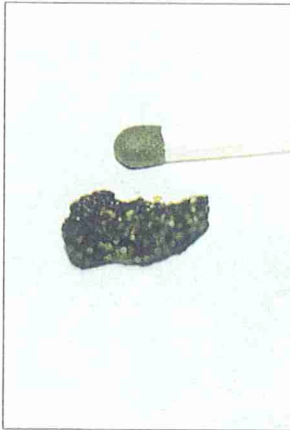
En rostflaga hade fastnat i röret från termostathuset till avgaslimpan. När som helst hade den kunnat stängt av kylvattnet med totalhaveri som följd!
