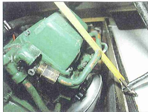
Det enda större ingreppet vid montering av sötvattenkylning består i att såga av ett rör från termostathuset med en bågfil.
