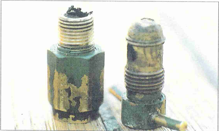
Motorns avtappningskran var helt igensatt med en fint, hårdpackat stoft. Inte en droppe kom igenom . . .
