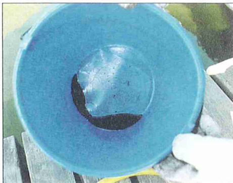
Efter en kraftig renspolning av motorn låg massor av större och mindre rostflagor kvar i botten av hinken.
