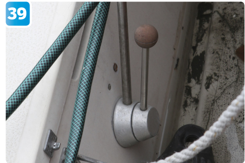
39 Det gamla motorreglaget monteras bort.
