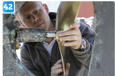
42 Den nya propellern ska monteras på den nya axeln.
