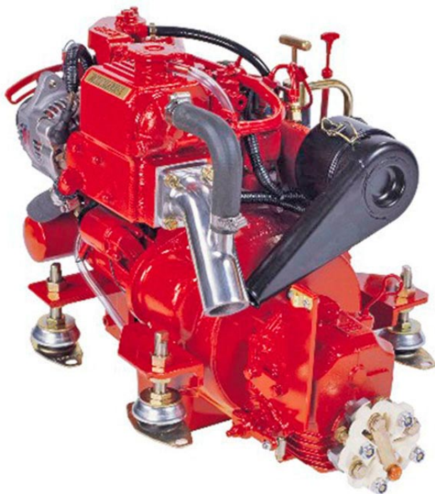
Beta Marine BZ-482 13,5 hkr/10kW med Technodrive backslag utväxling 2,6:1
