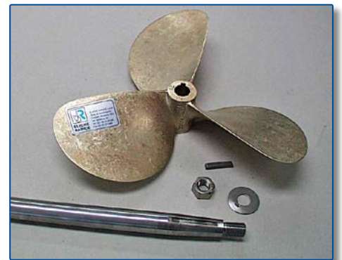
Denna 13x11V ersatte den tvåbladiga. Originalaxeln hade fel kona och var också skadad så även den byttes.
