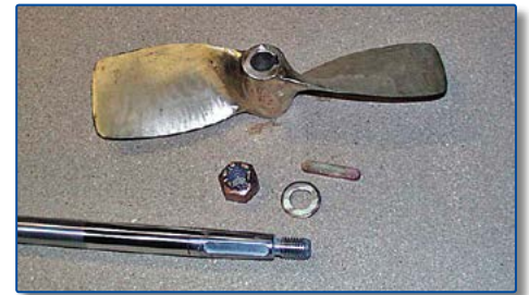
Original propeller 13x13V och axel från 1975.
