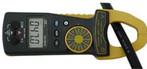
Ovanstående tångamperemätare (och voltmätare) för likström är både bra för felsökning och för att se hur mycket kapacitet man har kvar i batterierna enligt ovan. Man håller bara tångdelen runt kabeln för att se hur mycket ström det går i kabeln. Pris 2295 kr.
