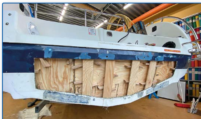
Först ett lager med glasfiberlaminat och i detta, ännu ohärdade, laminat limmade jag första lagret plywood. Ytterligare två lager plywood ska senare limmas fast.
