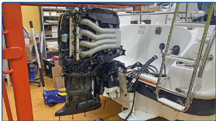
Motorn hängs av och utrustning demonteras.
