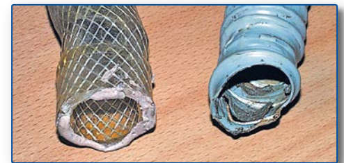
Original självläns-slangar från 1973 och 1975. Dessa måste bytas!
