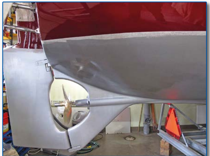
Efter att ha mattat ned epoxin lade jag på ett lager med International Primocon, det är egentligen onödigt men jag ville ha det så.
