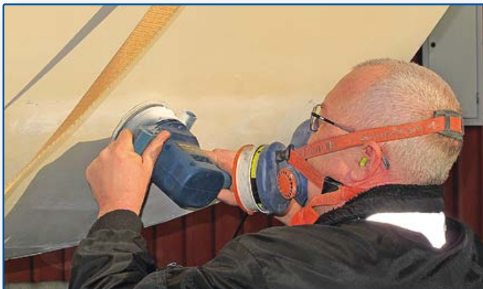
Ytterligare slipning av botten efter spackling, nu med 80-papper.
