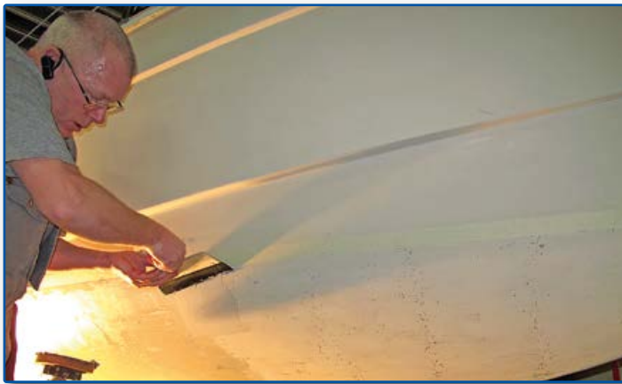
Botten spacklas med epoxi-spackel efter slipningen.
