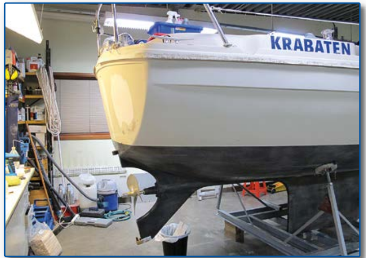
Andra lagret med epoxi har här lagts på vilket man ser på att undervattensskroppen nu är ett snäpp mörkare än på förra bilden.
