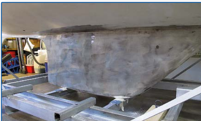
Första strykningen med epoxi påbörjad.
