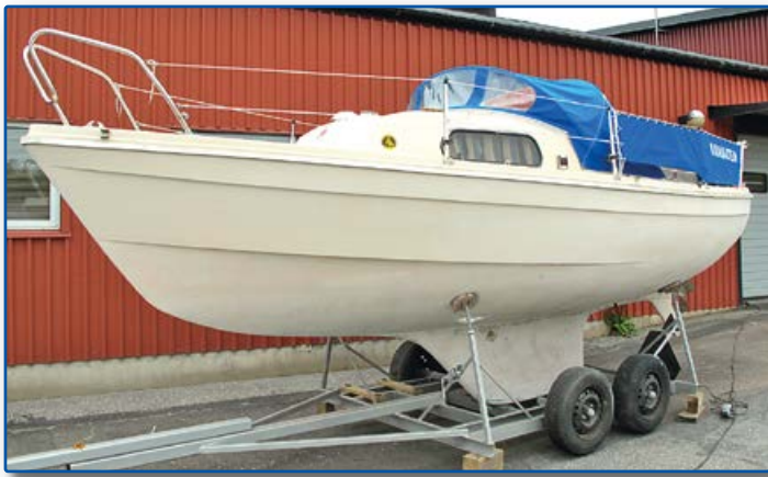
Här är faktiskt hela skrovet färdigslipat för jag målade friborden samtidigt. Friborden slipades med 180-papper.
