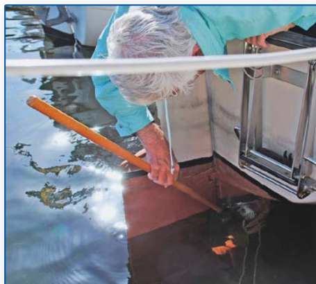
Löser problemet med rep i propellern.
